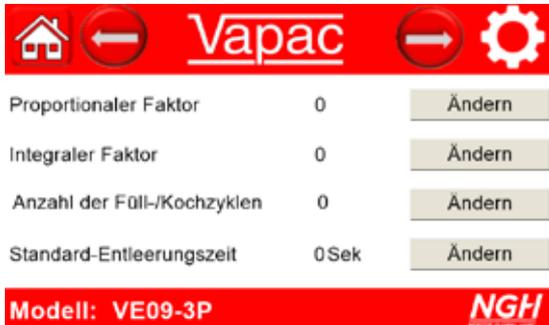
Der Vapac-Controller bietet PID-Steuerung (proportional, integral und differenzial), wenn er mit einem Feuchtigkeitssensor verwendet wird. In diesem Fall:-
