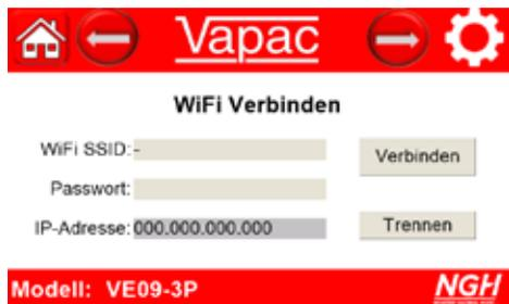
Durch die Verbindung über WIFI können Sie Einstellungen über eine Modbus-Anwendung aus der Ferne überwachen und ändern. In diesem Fall wird automatisch eine IP-Adresse vergeben.
