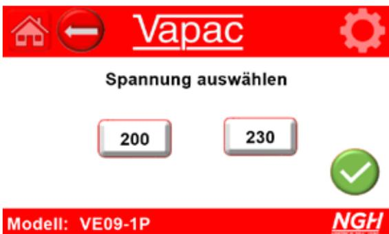
Bei einphasigen Modellen (VE05-1P und VE09-1P) bietet das System die Möglichkeit, die Spannung entsprechend der eingehenden Stromversorgung auszuwählen. Beachten Sie, dass 230V die deutsche Norm ist.
