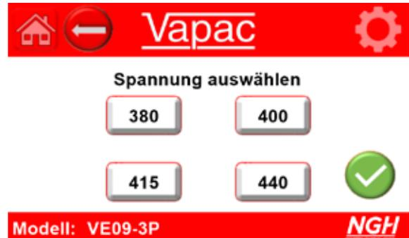
Bei dreiphasigen Modellen (VExx-3P) bietet das System die Möglichkeit, die Spannung entsprechend der eingehenden Stromversorgung auszuwählen. Beachten Sie, dass 400V der deutsche Standard ist.
